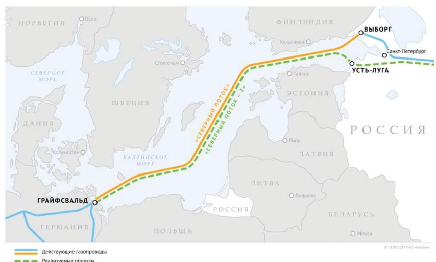
В проекте две параллельные нитки диаметром 48 дюймов каждая протяженностью около 1 225 км. от Балтийского берега в Ленинградской области до побережья в Германии недалеко от действующего газопровода «Северный поток», ежегодная пропускная способность каждой нитки – 27,5 млрд куб. м.
